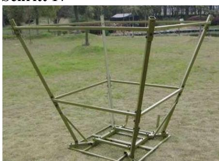
Montieren Sie 3xZ1, 1xZ2 (Lochbohrung nach vorne zum Leiterbereich!) unter Verwendung von 8x#5 M8x60.
