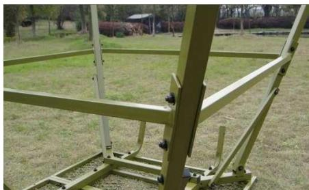
Montieren Sie 4xH unter Verwendung von 8x#5 M8x60.
