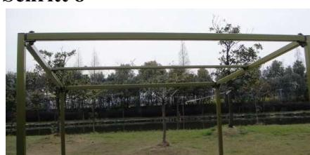
Montieren Sie 1xL unter Verwendung von 2x#9 M8x35.
